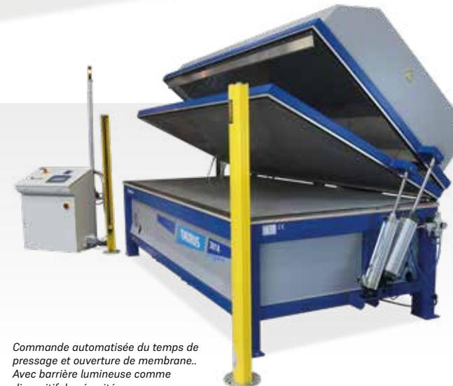
Commande automatisée du temps de pressage et ouverture de membrane.. Avec barrière lumineuse comme dispositif de sécurité.
