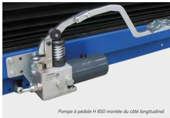
*Pompe à pédale H 850 montée du côté longitudinal*
