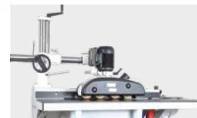
Nous recommandons un dispositif d'alimentation pour une surface uniforme
