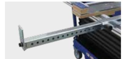
Table de montage avec dispositif de retournement intégré pour l'usinage de pièces massives jusqu'à 450 kg
