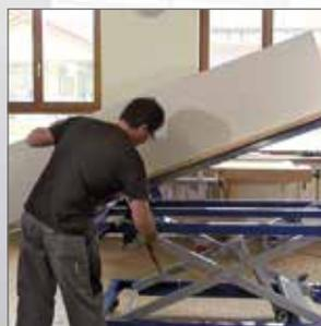
Der neue Arbeitstisch „kippLIFT“ erleichtert durch einfaches Auf- und Abladen den Transport von langen, schweren und sperrigen Teilen.
