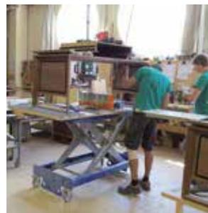
Fußpumpe, die automatisch die richtige Stufe wählt.
