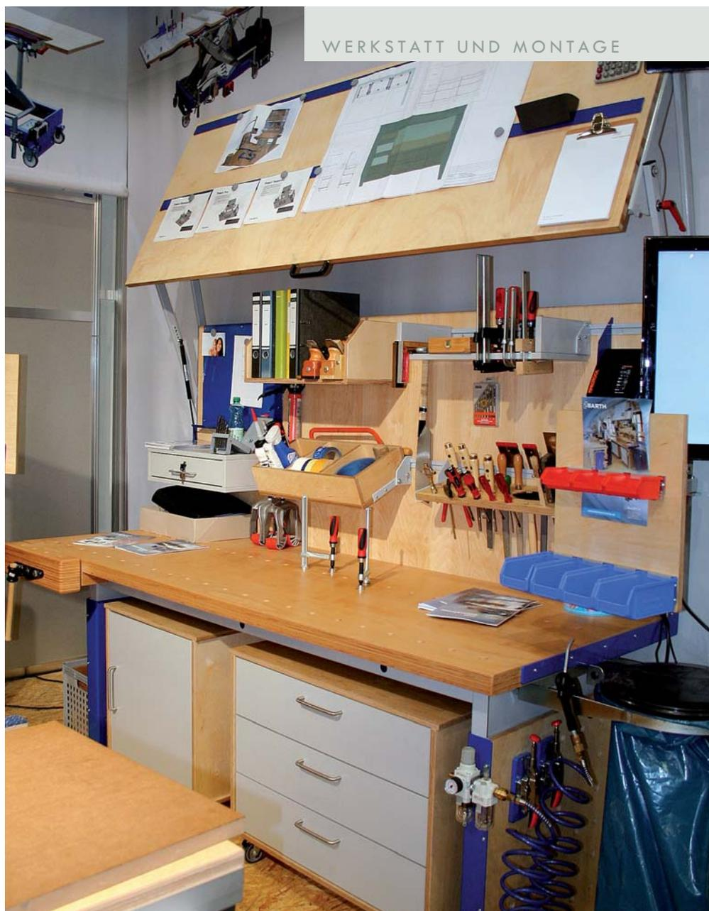
Die multifunktionale Werkbank „Orga“ kann mit verschiedensten Ablage- und Stecksystemen bestückt werden. Sehr praktisch ist der optionale Planhalter, der sich bei Bedarf einfach herunterziehen lässt.
