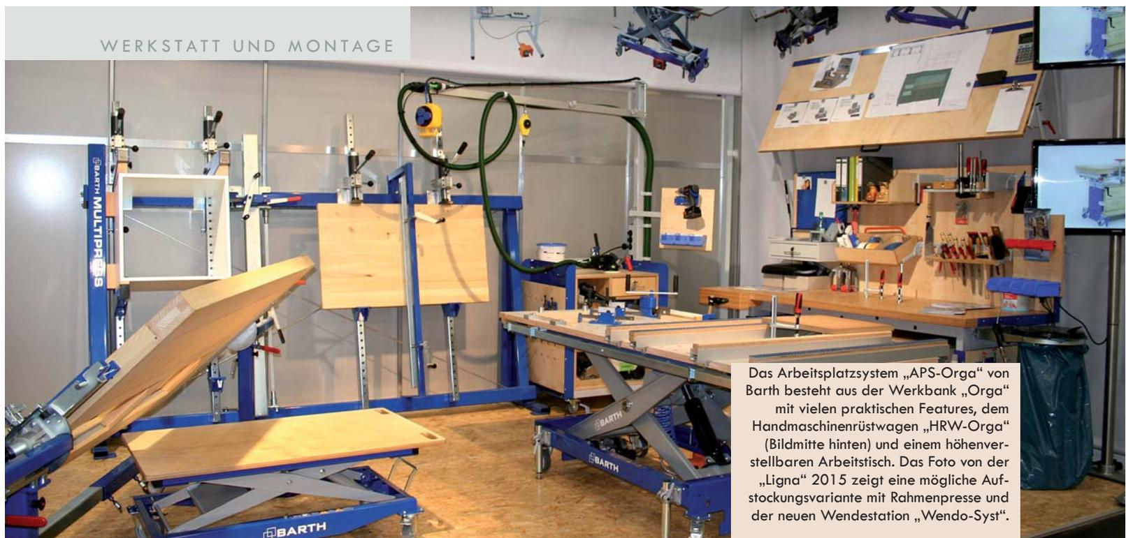
Das Arbeitsplatzsystem „APS-Orga“ von Barth besteht aus der Werkbank „Orga“ mit vielen praktischen Features, dem Handmaschinenrüstwagen „HRW-Orga“ (Bildmitte hinten) und einem höhenverstellbaren Arbeitstisch. Das Foto von der „Ligna“ 2015 zeigt eine mögliche Aufstockungsvariante mit Rahmenpresse und der neuen Wendestation „Wendo-Syst“.
