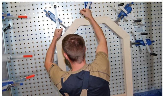
Michael Thaler tastet sich mit den Spannern an den Fensterbogen heran bis die Brüstungen zwischen den CNC-gefrästen Segmenten dicht sind
